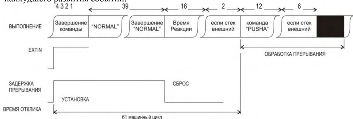
Рисунок 6.3 – Время реагирования на стандартное прерывание
