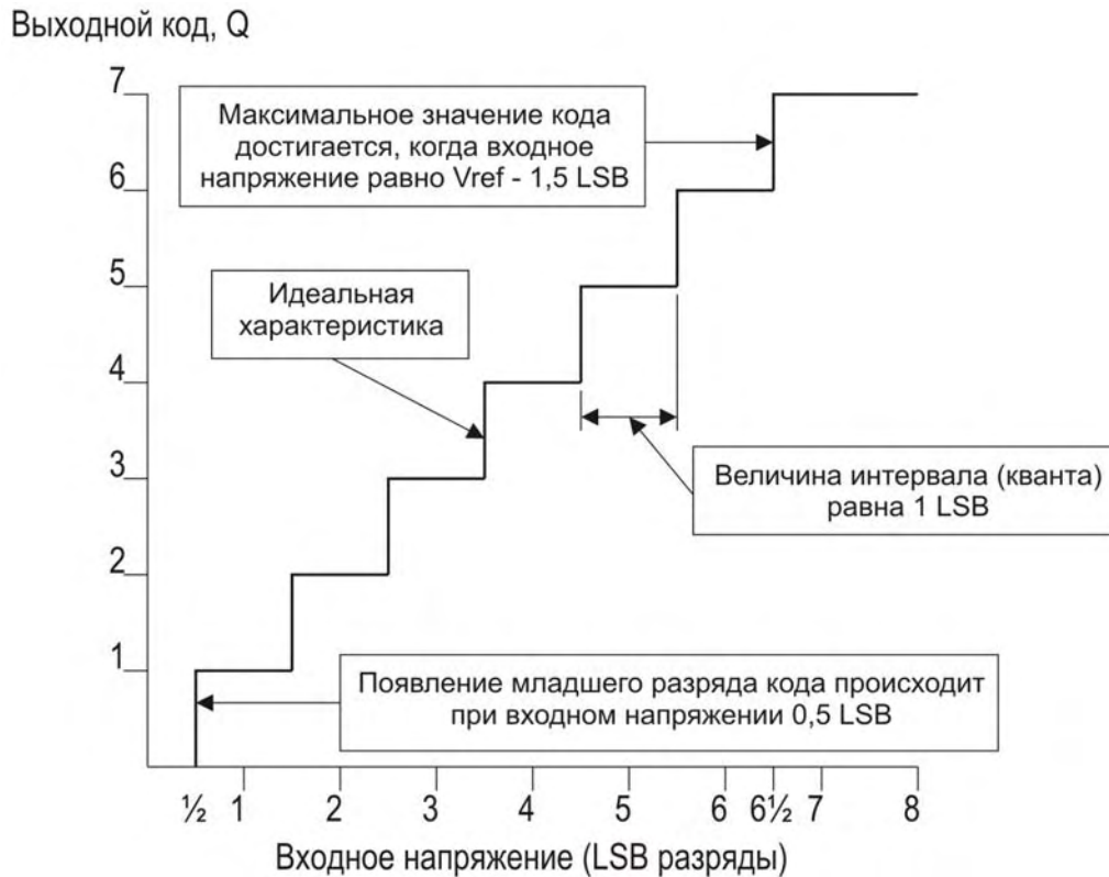
Рисунок 10.8 – Идеальная передаточная характеристика АЦП
