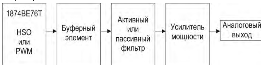
Рисунок 11.3 – Блок-схема буферизации цифроаналогового преобразователя
