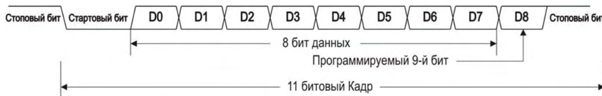
Рисунок 8.4 – Кадр последовательного порта в режимах 2 и 3
