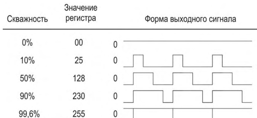
Рисунок 11.2 – Форма выходного сигнала PWM
