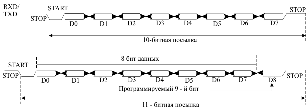
Рисунок 10.3.2 - Работа последовательного порта в режимах 1,2 и 3
