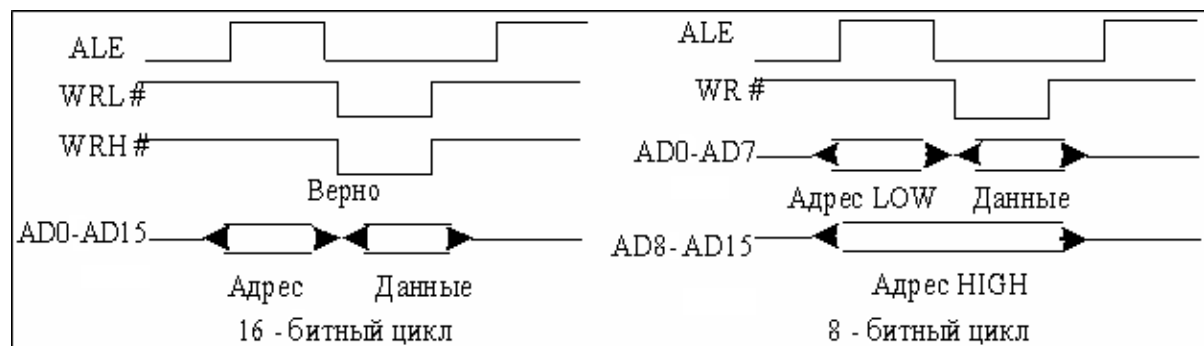
Рисунок 15.2.2 – Режим стробирования записи
