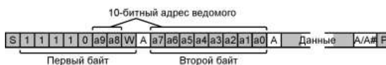
Рисунок 13.10 – Передача данных ведомому с 10-битным адресом (для расшифровки обозначений, применяемых на рисунке, следует обратиться к таблице 13.1)
