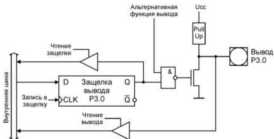
Рисунок 3.4 – Функциональная схема канала порта 3
