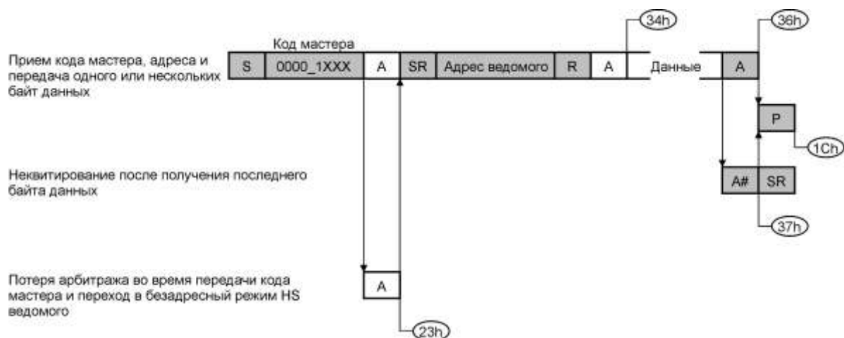
Рисунок 13.23 – Режим HS ведомого передатчика
