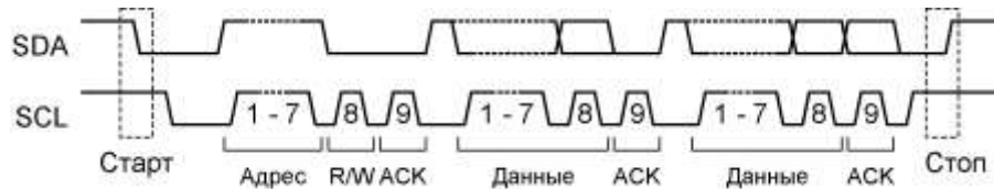
Рисунок 13.8 – Передача данных с 7-битной адресацией
