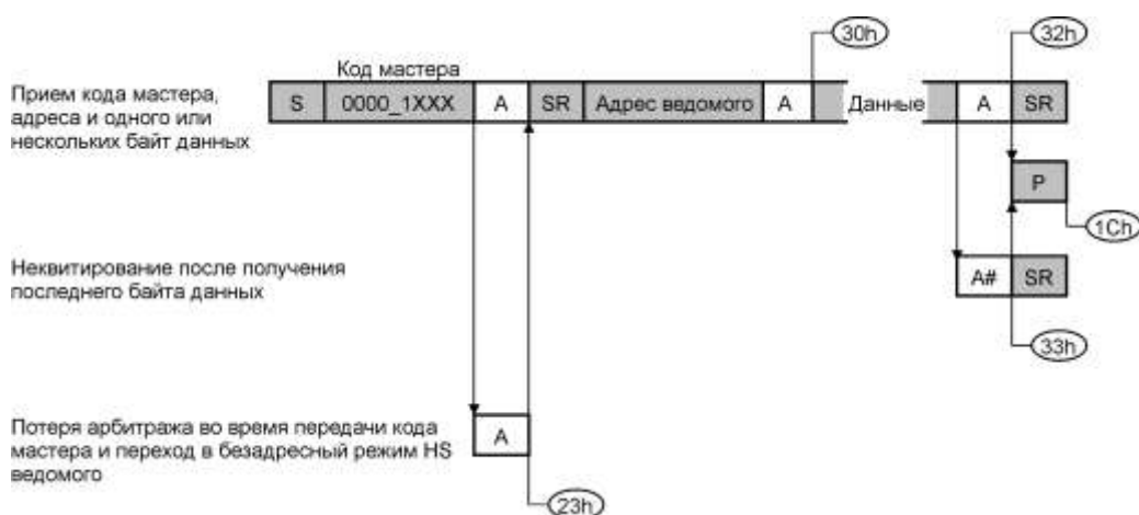
Рисунок 13.21 – Режим HS ведомого приемника
