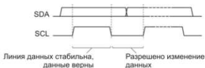
Рисунок 13.1 – Передача бита данных
