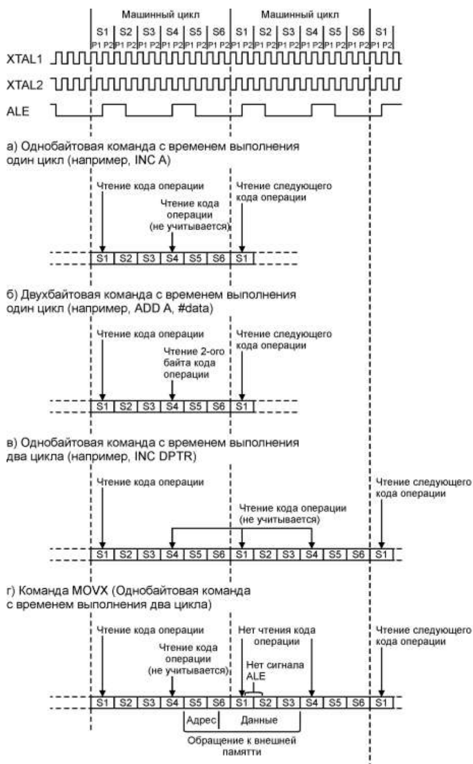
Рисунок 6.3 – Последовательность состояний микроконтроллера
