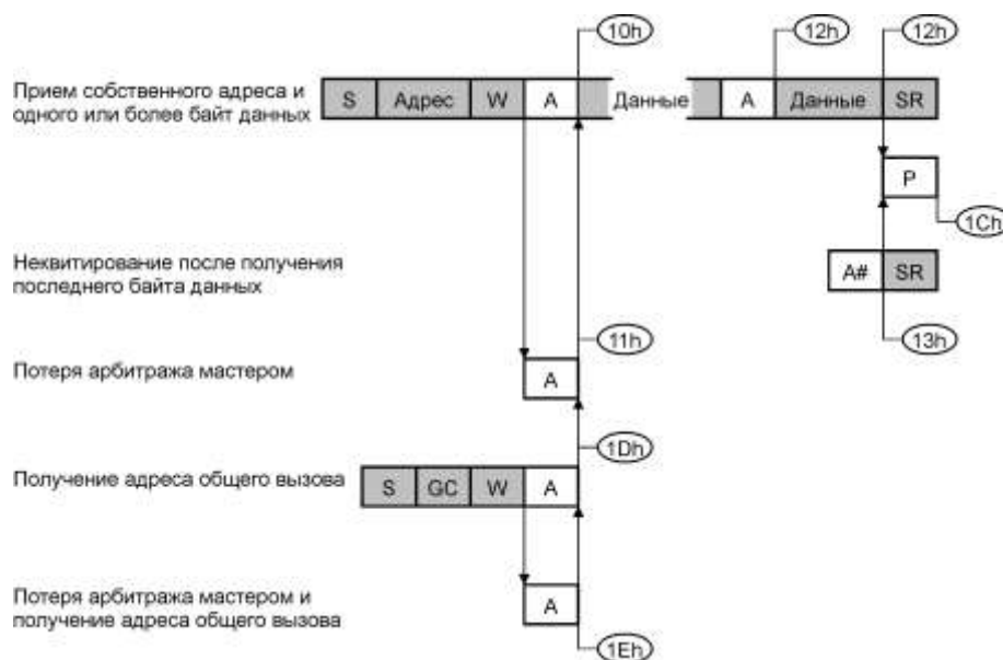
Рисунок 13.20 – Режим FS ведомого приемника
