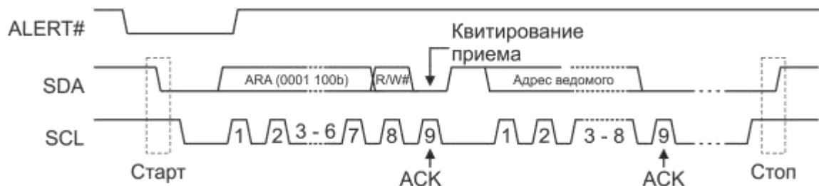
Рисунок 13.9 – Передача адреса отклика на сигнал предупреждения
