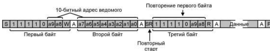
Рисунок 13.11 – Получение данных от ведомого с 10-битным адресом
